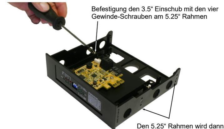
Befestigung den 3.5" Einschub mit den vier Gewinde-Schrauben am 5.25" Rahmen
